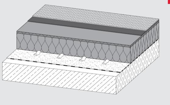
Feuchtigkeitserhärtender, gering expandierender Einkomponenten-Polyurethan-Klebstoff für die Verklebung von druckbelastbaren Mineralwolle-Dämmstoffen.
